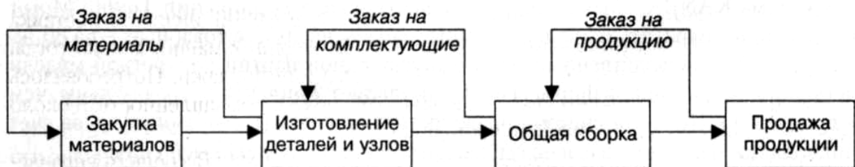
Рис. 1.3. Схема организации производства по методу «точно в срок» («Канбан»)
