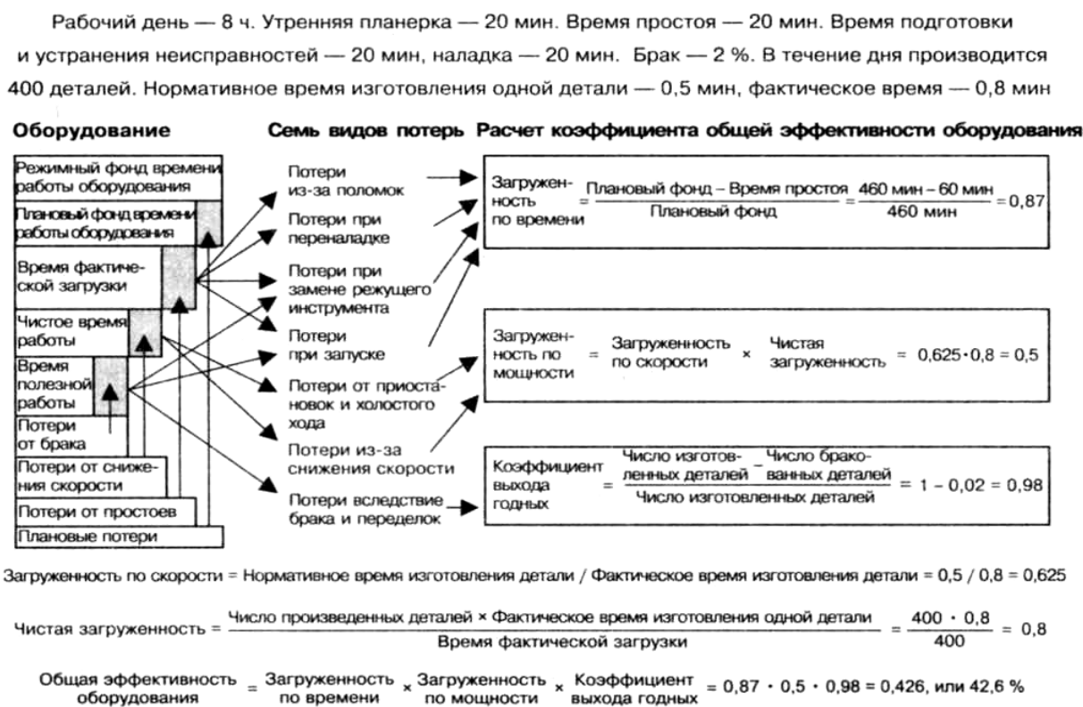
Рис. 5.3. Методика и пример расчета коэффициента общей эффективности оборудования
